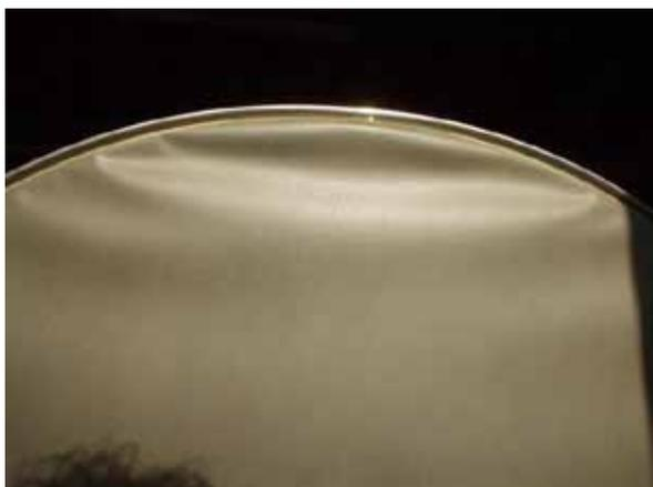
Normalmente, questo tipo di danno abbastanza frequente, si riscontra a seguito della caduta della pelle che, come effetto immediatamente verificabile, produce una deformazione dell'anello metallico su cui è termosaldata la membrana. Questo accade per effetto di un sensibile "appiattimento" sulla
